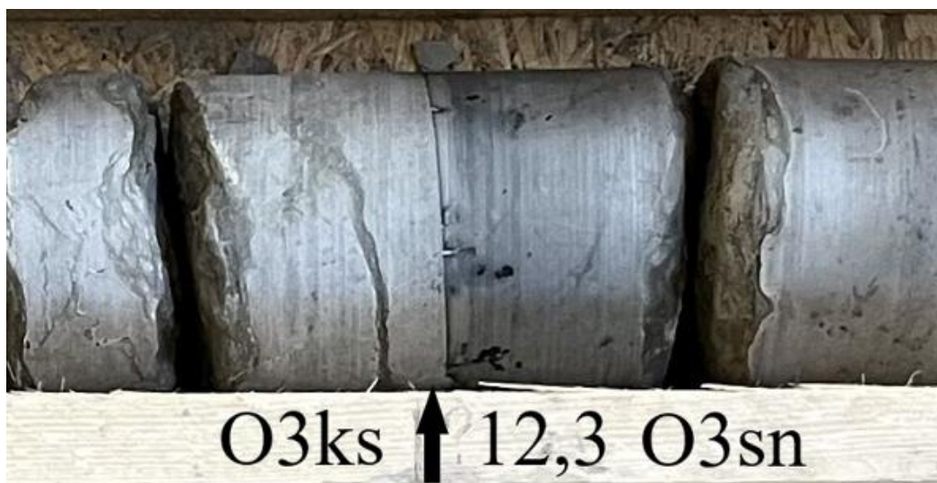
Foto 4. Kõrgessaare ja Saunja kihistute vaheline piir sügavusel 12,3 m on hästi nähtav - püriitse impregnatsiooniga katkestuspind (PA4).
