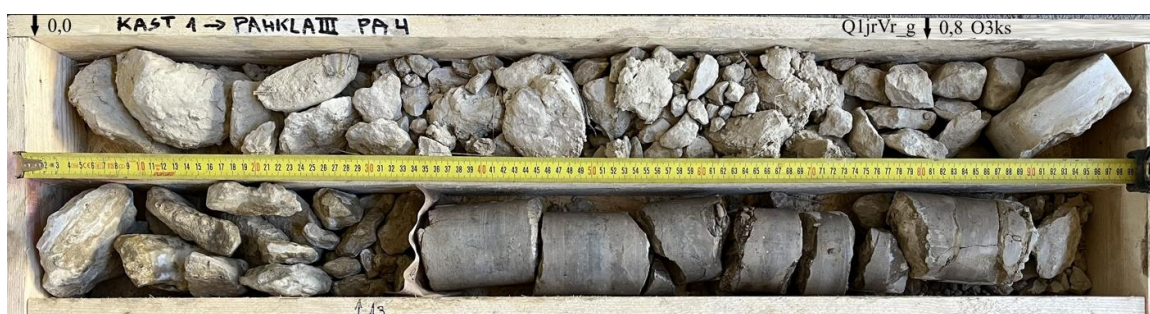
Foto 1. Katend puuraugus PA4. Pildil kuni 0,8 m sügavusel paerähkne moreen ja sealt edasi 0,5 m paksune murenenud lubjakivi.
