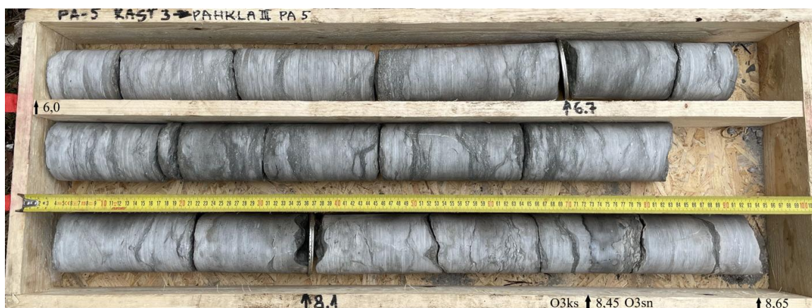
Foto 3. Hallikas lubjakivi tumehallide, kohati ebaselgelt piiritletud tumedamate merglikihtidega. Paiguti on mugulja tekstuuriga lubjakivi (PA5).
