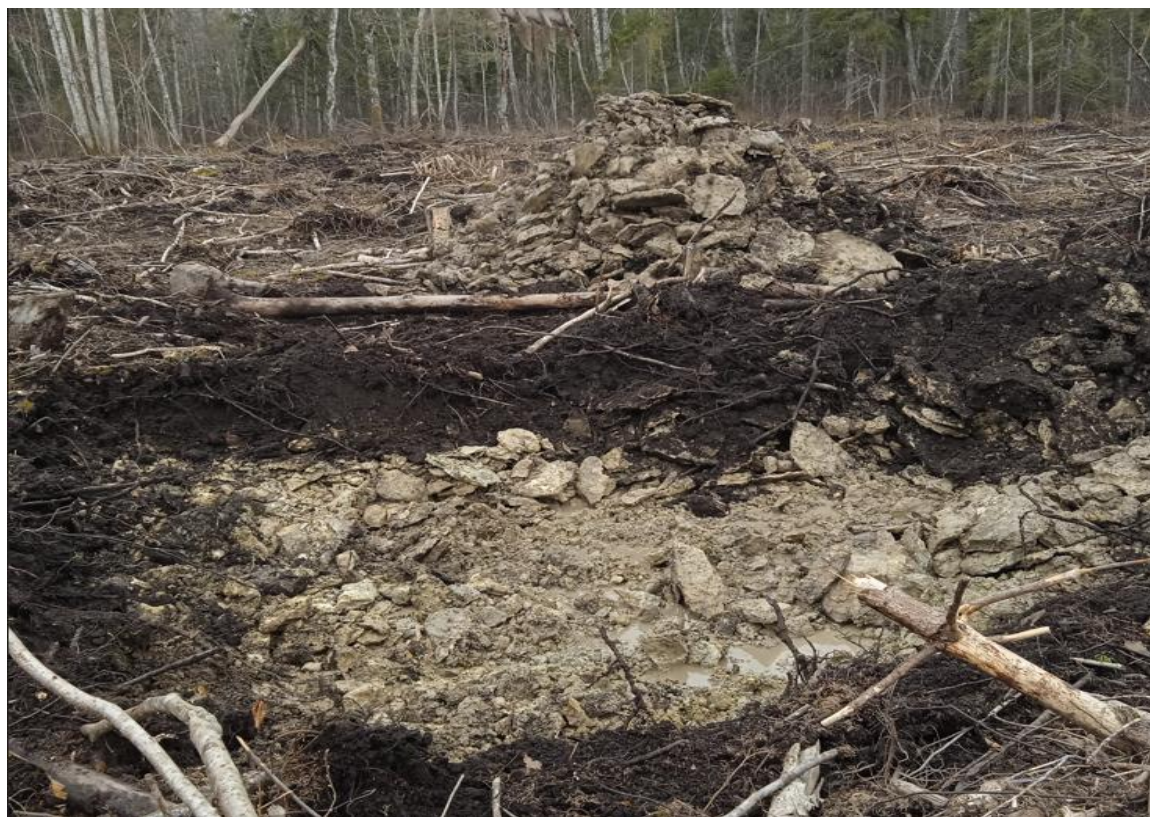
Foto 2. Katend kaevandis K1. Kasvu- ja mullakihi all on mergli vahekihtidega murenenud lubjakivi ja suured lubjakivi plaadid.
